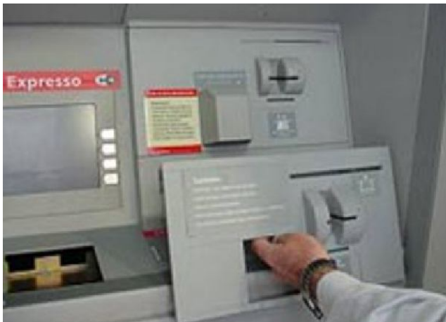
LECTOR DE TARJETA FALSO SOBREPUESTO
