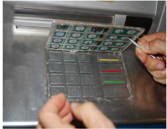
DISPENSADOR DE EFECTIVO FALSO SOBREPUESTO
