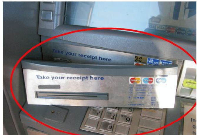
DISPENSADOR DE EFECTIVO FALSO SOBREPUESTO
